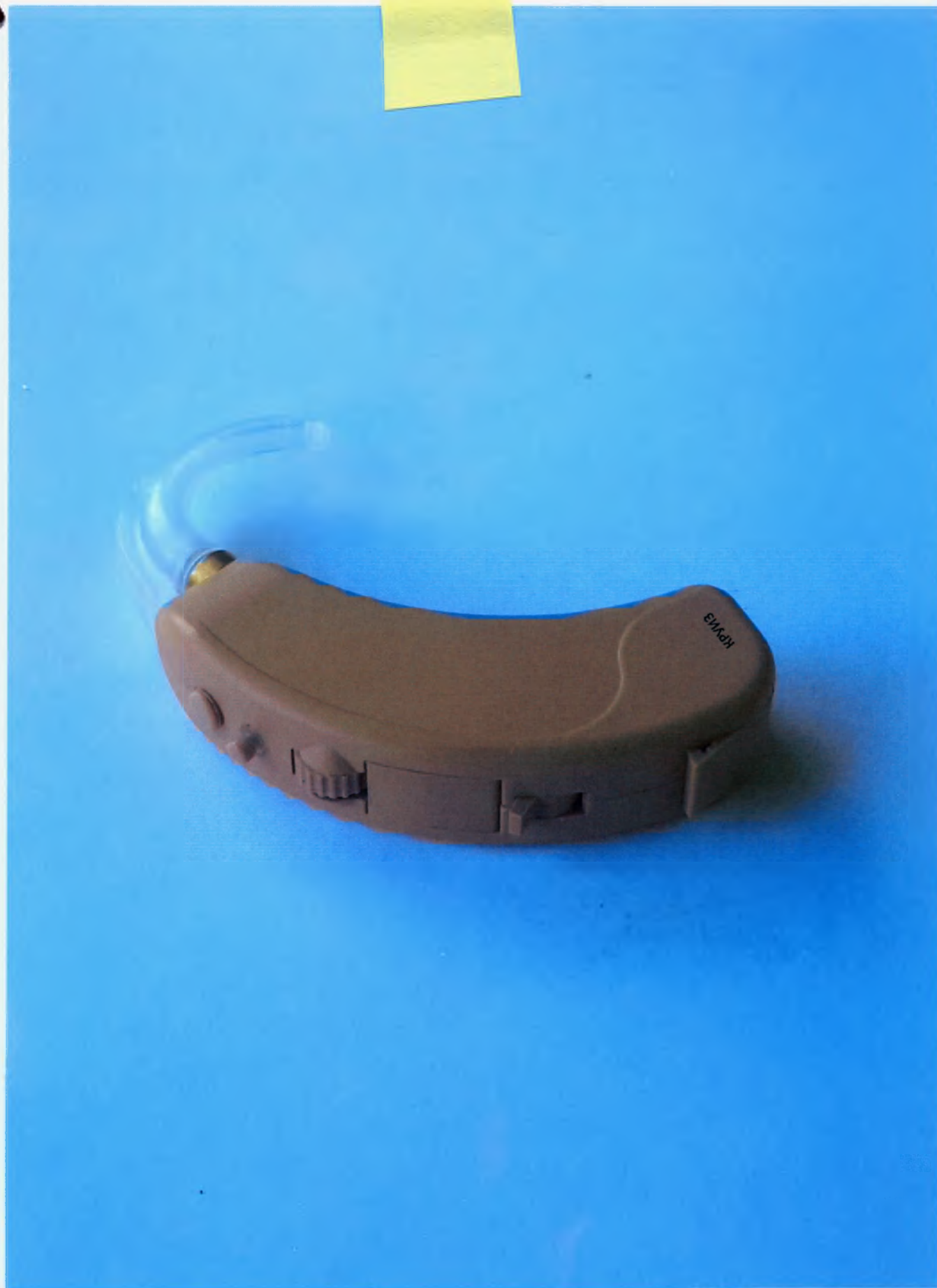
ФОТОГРАФИЯ АППАРАТА СЛУХОВОГО ЭЛЕКТРОННОГО ЦИФРОВОГО ТРИММЕРНОГО, ПРОГРАММИРУЕМОГО ВОЗДУШНОГО ЗВУКОПРОВОЖДЕНИЯ ЗАУШНОГО ТИПА "КРУИЗ".
