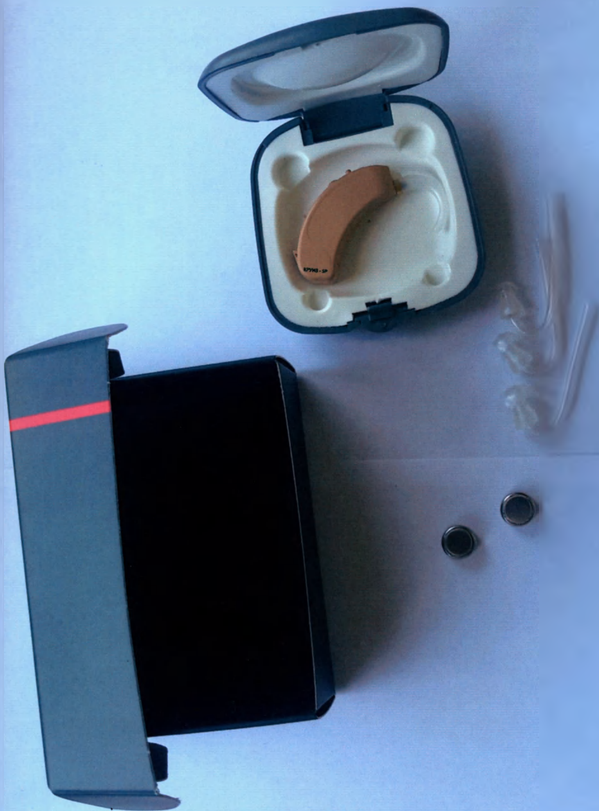
ФОТОГРАФИЯ АППАРАТА СЛУХОВОГО ЭЛЕКТРОННОГО ЦИФРОВОГО БИМЕРНОГО, ПРОГРАММИРУЕМОГО ВОЗДУШНОГО ЗВУКОПРОВОДЕНИЯ ЗАУШНОГО АПА "КРУИЗ - SP", С ПРИНАДЛЕЖНОСТЯМИ: ЗВУКОПРОВОД №1, №2, №3; ЭЛЕМЕНТ ТАНИЯ 1,4 В, ТИП 675; ФУТЛЯР; КОРОБКА.
