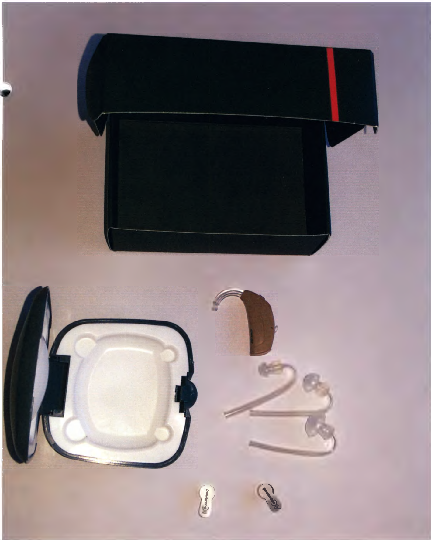
ФОТОГРАФИЯ АППАРАТА СЛУХОВОГО ЭЛЕКТРОННОГО ЦИФРОВОГО ПРОГРАММИРУЕМОГО ВОЗДУШНОГОЗВУКОПРОВЕДЕНИЯ ЗАУШНОГО ТИПА «ХЕЛИОС 12НР» С ПРИНАДЛЕЖНОСТЯМИ : ЗВУКОПРОВОД №1, №2, №3; ЭЛЕМЕНТ ПИТАНИЯ 1,4 В, ТИП 13; ФУТЛЯР; КОРОБКА.
