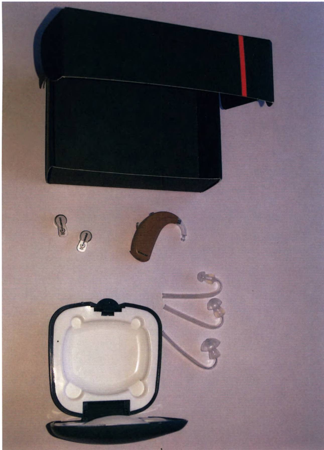
ФОТОГРАФИЯ АППАРАТА СЛУХОВОГО ЭЛЕКТРОННОГО ЦИФРОВОГО ПРОГРАММИРУЕМОГО ВОЗДУШНОГОЗВУКОПРОВЕДЕНИЯ ЗАУШНОГО ТИПА «ХЕЛИОС 8SP» С ПРИНАДЛЕЖНОСТЯМИ : ЗВУКОПРОВОД №1, №2, №3; ЭЛЕМЕНТ ПИТАНИЯ 1,4 В, ТИП 675; ФУТЛЯР; КОРОБКА.
