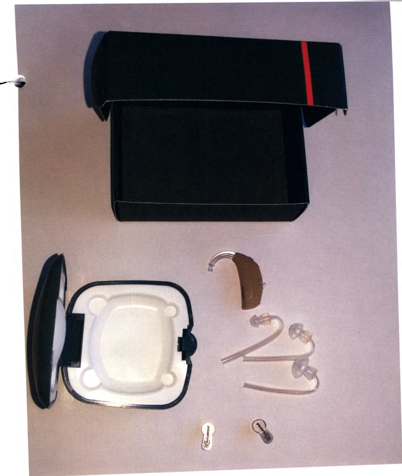
ФОТОГРАФИЯ АППАРАТА СЛУХОВОГО ЭЛЕКТРОННОГО ЦИФРОВОГО ПРОГРАММИРУЕМОГО ВОЗДУШНОГОЗВУКОПРОВОЖДЕНИЯ ЗАУШНОГО ТИПА «ХЕЛНОС 20НР» С ПРИНАДЛЕЖНОСТЯМИ : ЗВУКОПРОВОД №1, №2, №3; ЭЛЕМЕНТ ПИТАНИЯ 1,4 В, ТИП 13; ФУТЛЯР; КОРОБКА.
