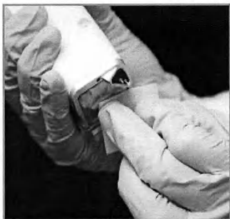
Рисунок 61. Протрите выходное окно, как показано на рисунке
