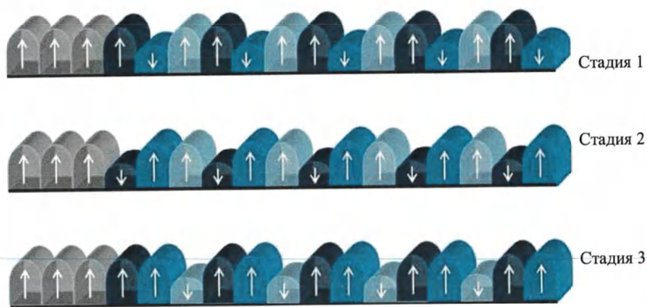
Рис 4. Принцип работы системы Euro Basic при 3 – х компрессоре. Каждый цикл охватывает все показанные стадии (стадии 1-3) и быструю стадию спуска воздуха перед началом нового цикла.
