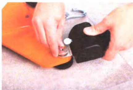
Изображение 11: Установка системы предотвращения опрокидывания
