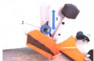
Изображение 20: Регулировка стандартной подставки для ног
