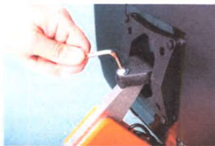
Изображение 6: Зафиксируйте ПК All-IN-ONE на кронштейне
