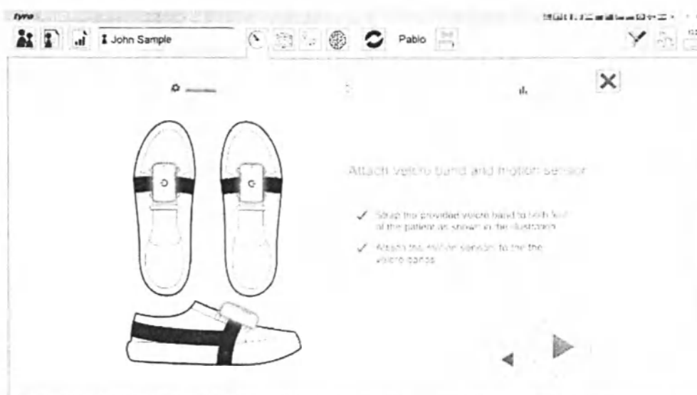
Рис. 36 Расположение датчиков движения PABLO для PABLO Оценки походки
