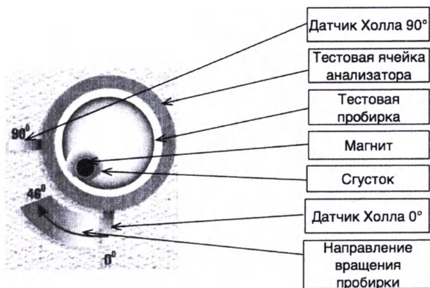
Рис. 2-1 блок-схема указанием функциональных элементов, ответственных за проведение анализов
