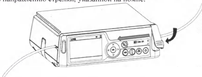
Рис. 15. Установка инфузионной магистрали. Шаг 3.
