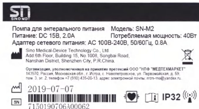
Рис. 3. Пример маркировки помпы для энтерального питания SN-M2.
