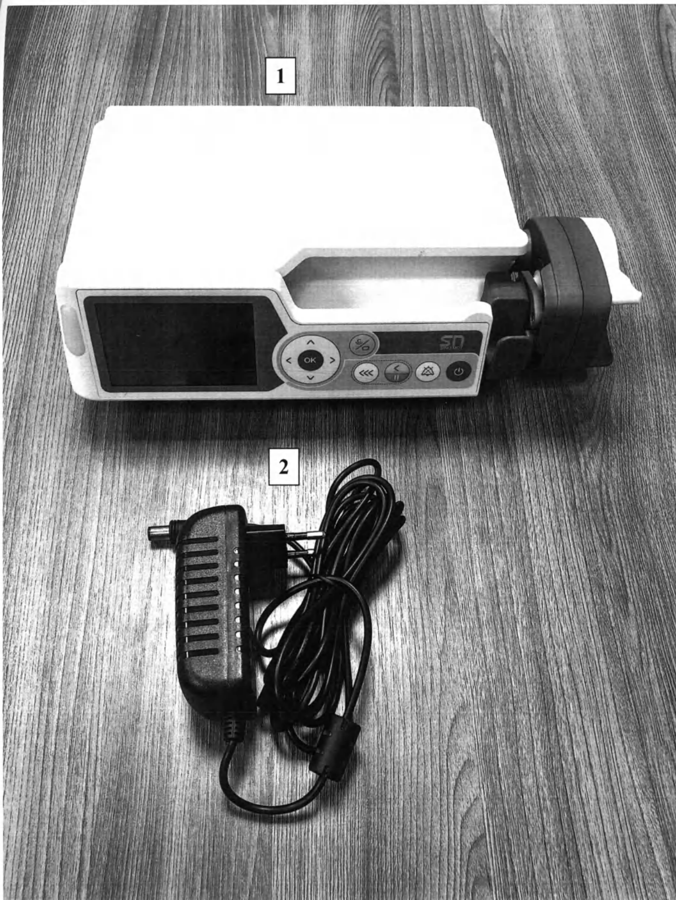
Фотографическое изображение помпы для энтерального питания SN-M1/SN-M2 (1) и адаптера сетевого питания (2).
