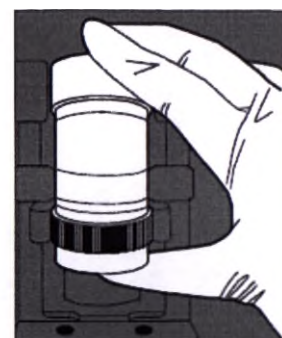
Рис.4. Установка вialы Cellprep в процессор Cellprep
