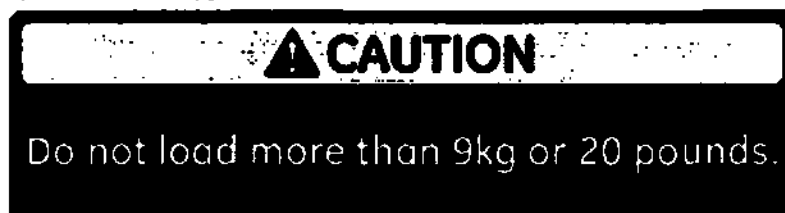
Рис. 3-12 Ограничения нагрузки на поддон
