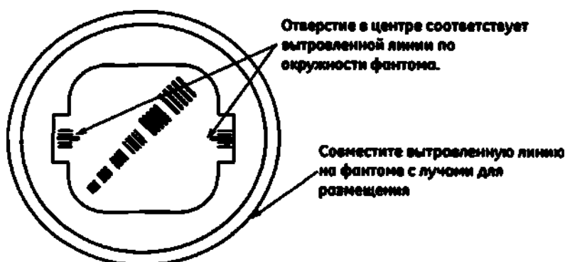
Рис. 12-12 Сегмент луча выравнивания
