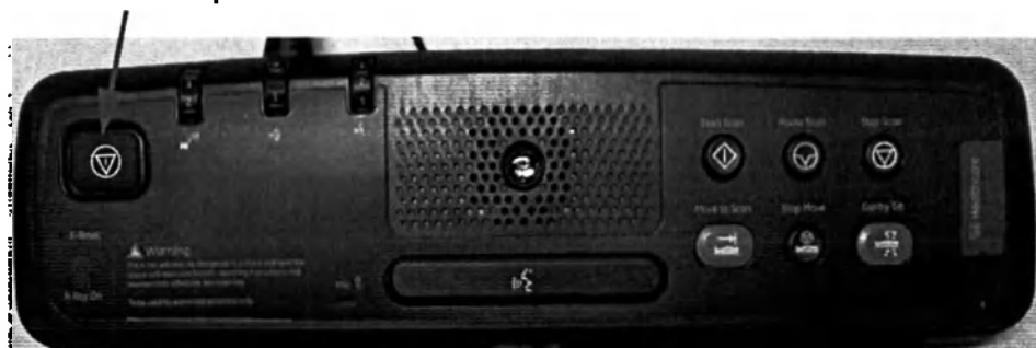
Рис. 3-28 Кнопка аварийной остановки на GSCB
