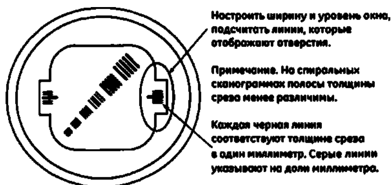
Рис. 12-11 Линии толщины среза
