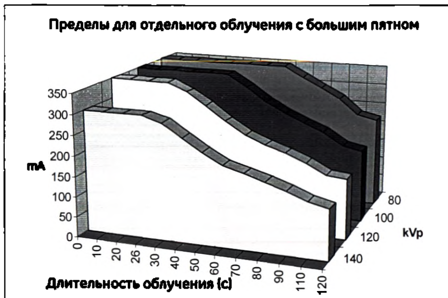
Рис. 14-9 Пределы для отдельного облучения с большим пятном (75 кВА)
