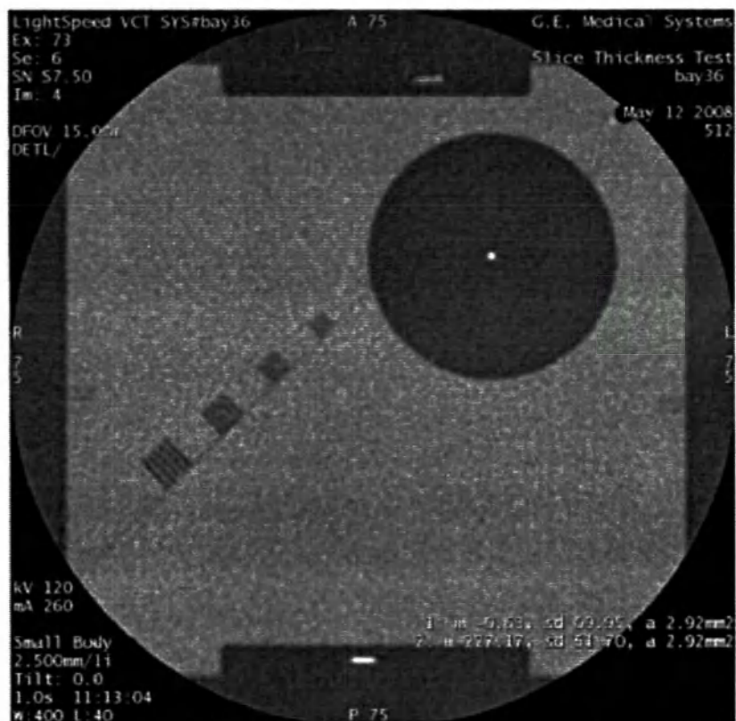
Рис. 13-6 Поместите два ROI для измерения числа КТ провода и фона.
