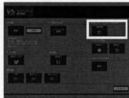
Настройка останова вращения револьверной головки по оси Z (при настройке останова вращения выбирается данная кнопка.)
