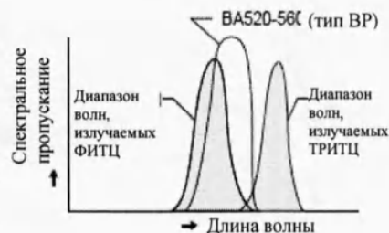
Фильтр пропускания в длинноволновой области спектра (видимы изображения ФИТЦ и ТРИТЦ)
