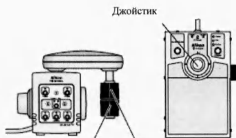
Рукоятка регулировки перемещения по оси X Рукоятка регулировки перемещения по оси Y
