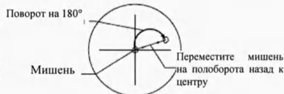
Центровочные винты предметного столика (и зажимной винт вращения предметного столика обеих сторонах)
