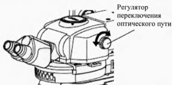
Переключение оптического пути вручную Распределение света при переключении оптического пути
