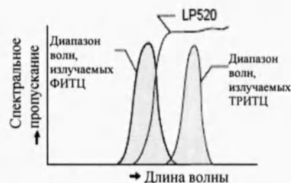
Фильтр пропускания в длинноволновой области спектра (видимы изображения ФИТЦ и ТРИТЦ)
