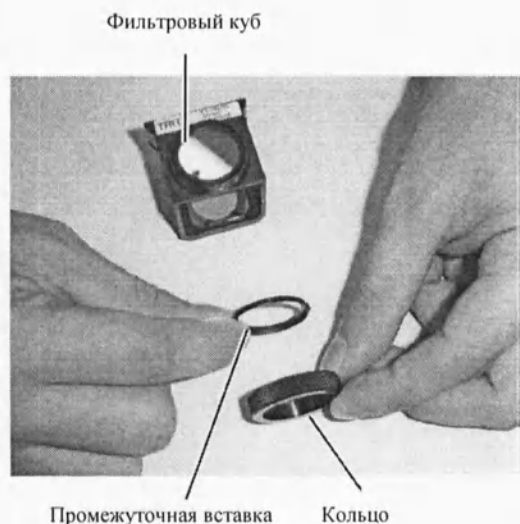
Снятие/крепление внутренней промежуточной вставки
