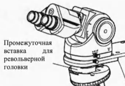
Использование промежуточной вставки для револьверной головки
