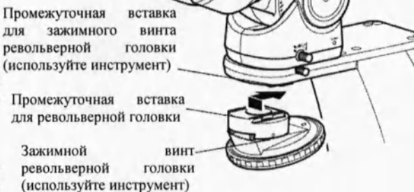
Крепление промежуточной вставки для револьверной головки
