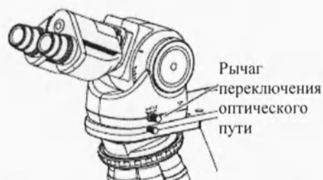
Переключение оптического пути тубуса
