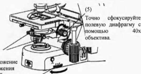
(6) Отрегулируйте размер изображения полевой диафрагмы до размера поля зрения.
