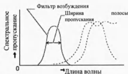
Ширина полосы пропускания фильтра возбуждения
