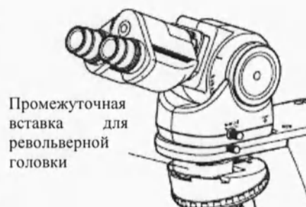
Использование промежуточной вставки для револьверной головки
