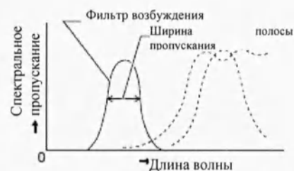
Ширина полосы пропускания фильтра возбуждения
