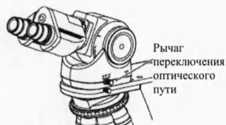
Переключение оптического пути тубуса
