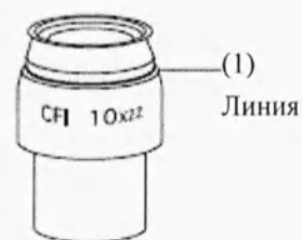
Исходное положение для диоптрической коррекции
