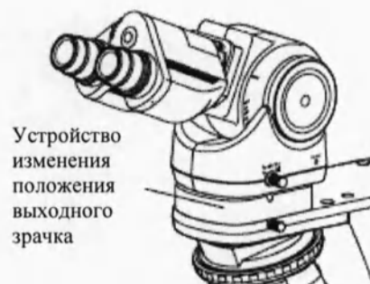
Использование устройства изменения положения выходного зрачка
