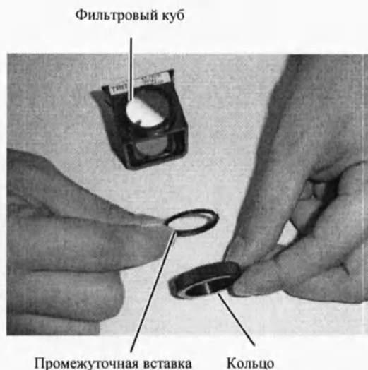
Снятие/крепление внутренней промежуточной вставки
