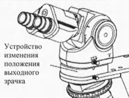
Использование устройства изменения положения выходного зрачка
