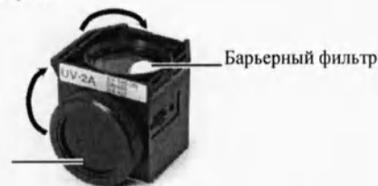
Замена фильтров возбуждения и барьерных фильтров
