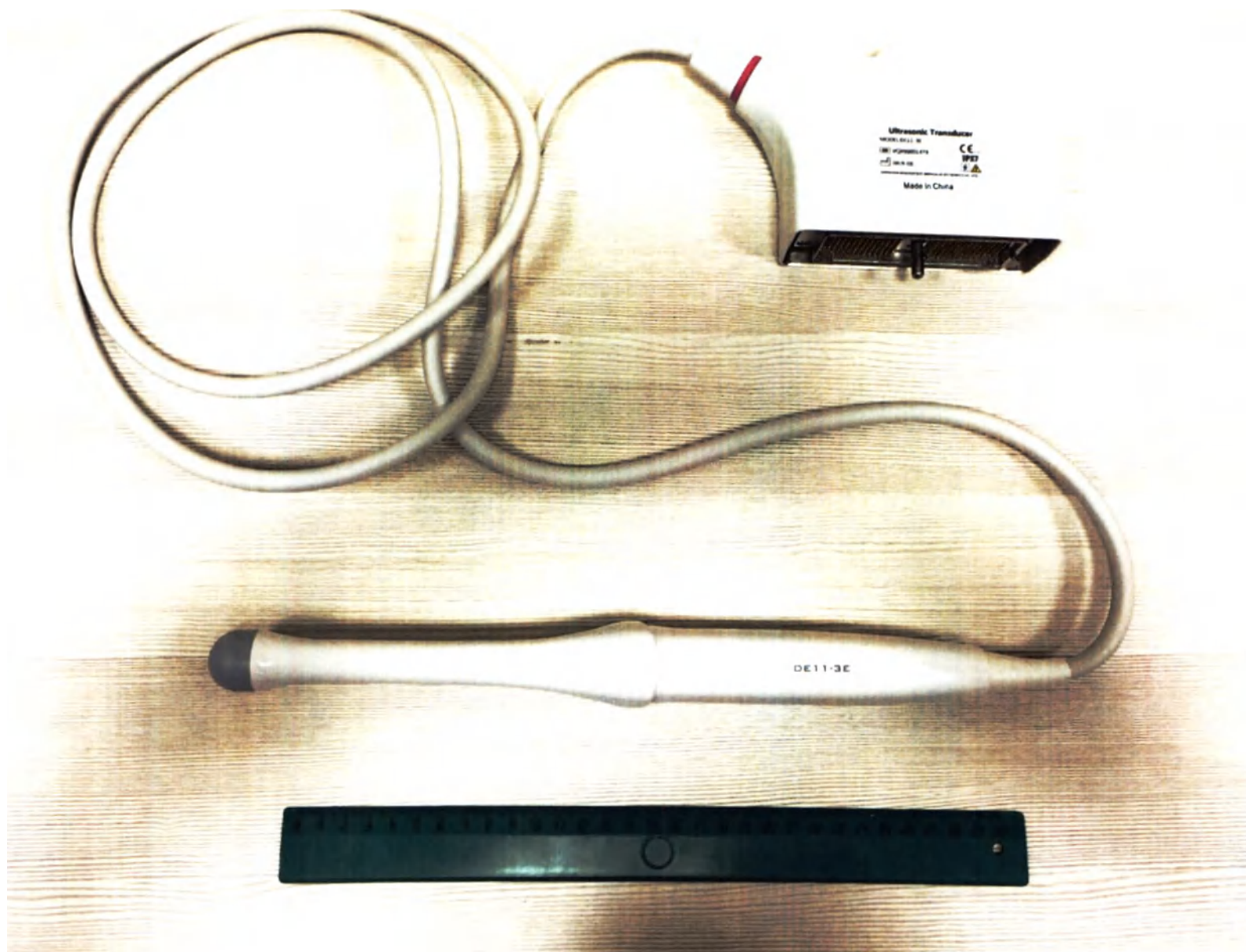
Датчик ультразвуковой объемный внутриполостной DE11-3E (Endocavity volume convex array transducer, DE11-3E)
