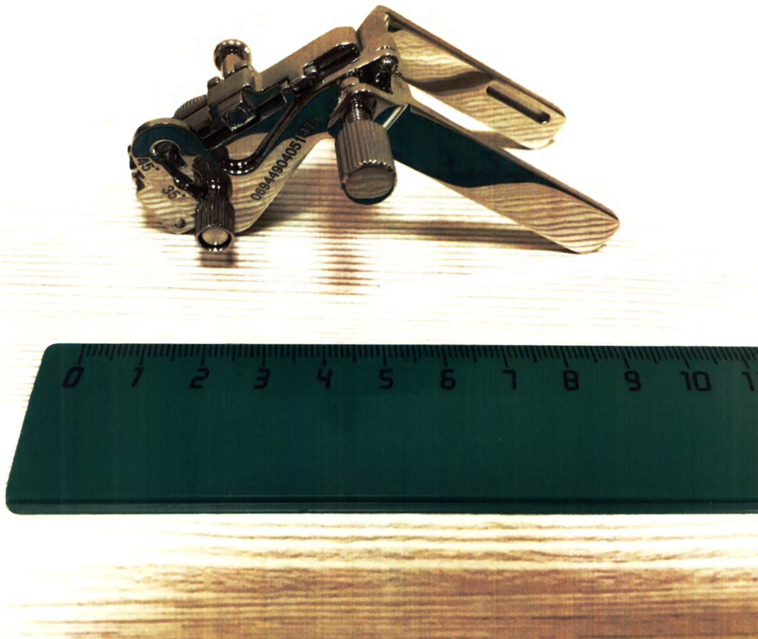
Биопсийная насадка (Needle guided bracket), тип: NGB-022
