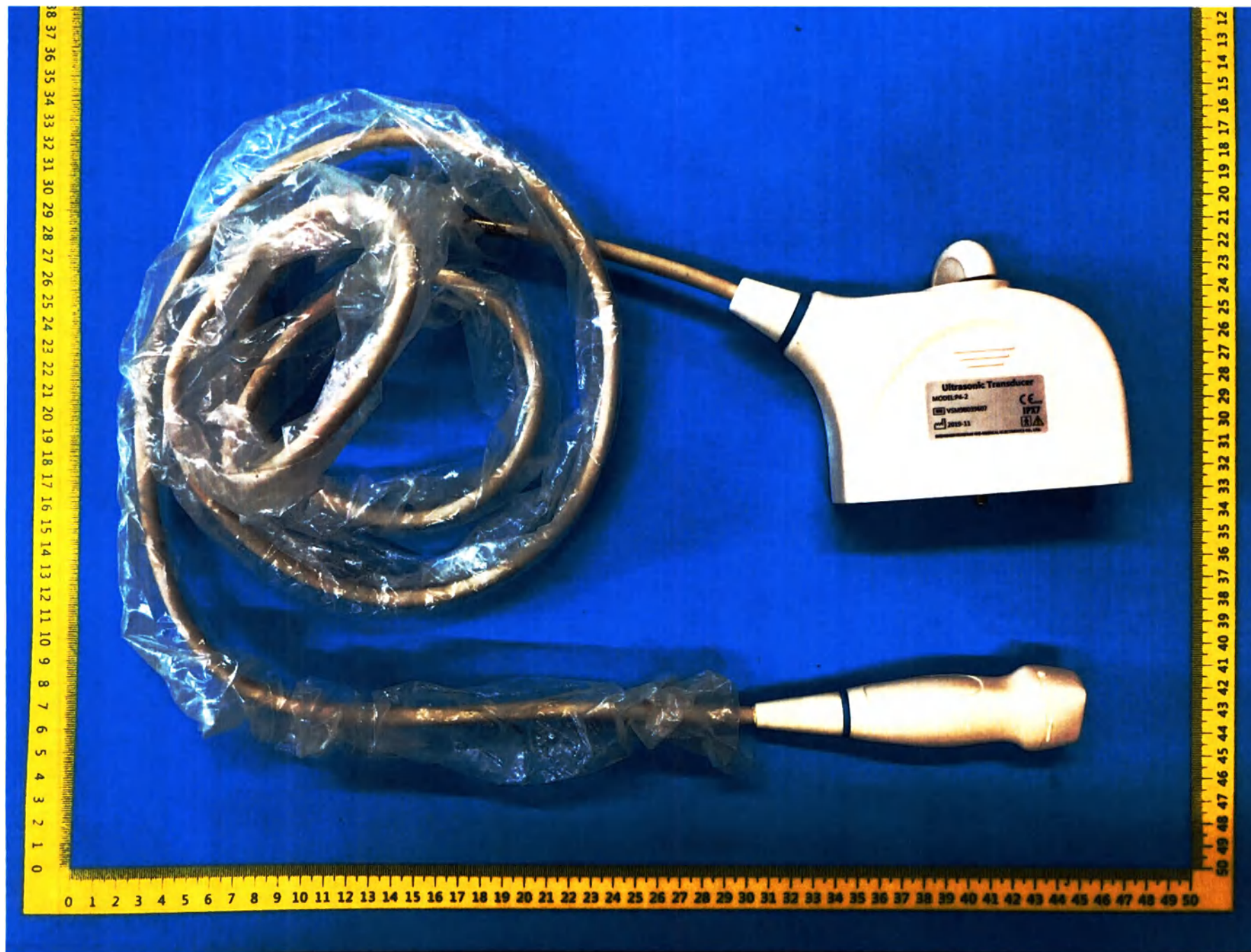
Датчик ультразвуковой фазированный P4-2 (Phased array transducer, P4-2)
