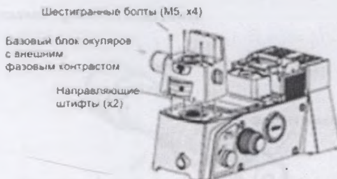
Рисунок 4-5 Установка базового блока окуляров с внешним фазовым контрастом
