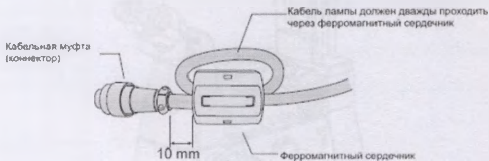
Рисунок 4-15 Фиксация кабеля
