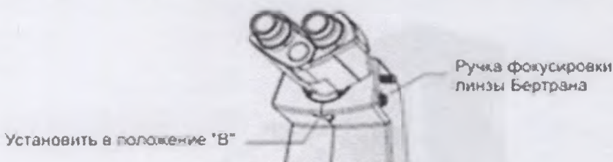
Рисунок 3.5-3 Регулировка линзой Бертрана
