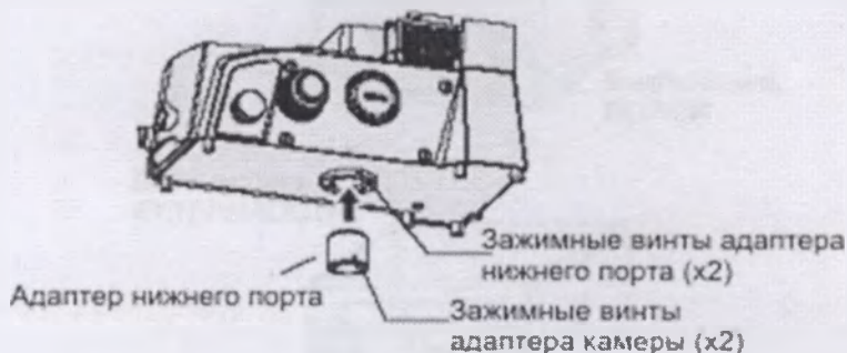
Рисунок 4-37 Установка адаптера нижнего порта
