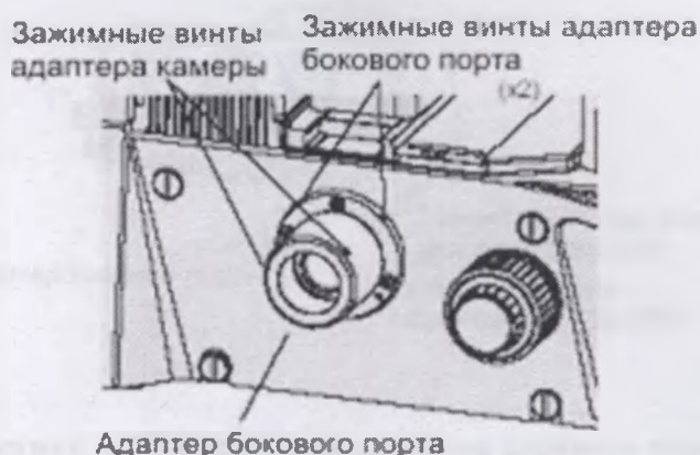
Рисунок 4-36 Установка адаптера бокового порта
