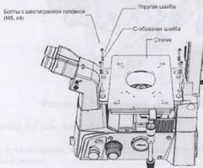
Рисунок 4-23 Установка предметного столика
