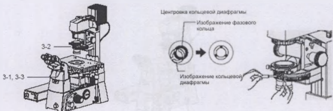
Рисунок 2.2-15 Центрирование кольцевой диафрагмы
