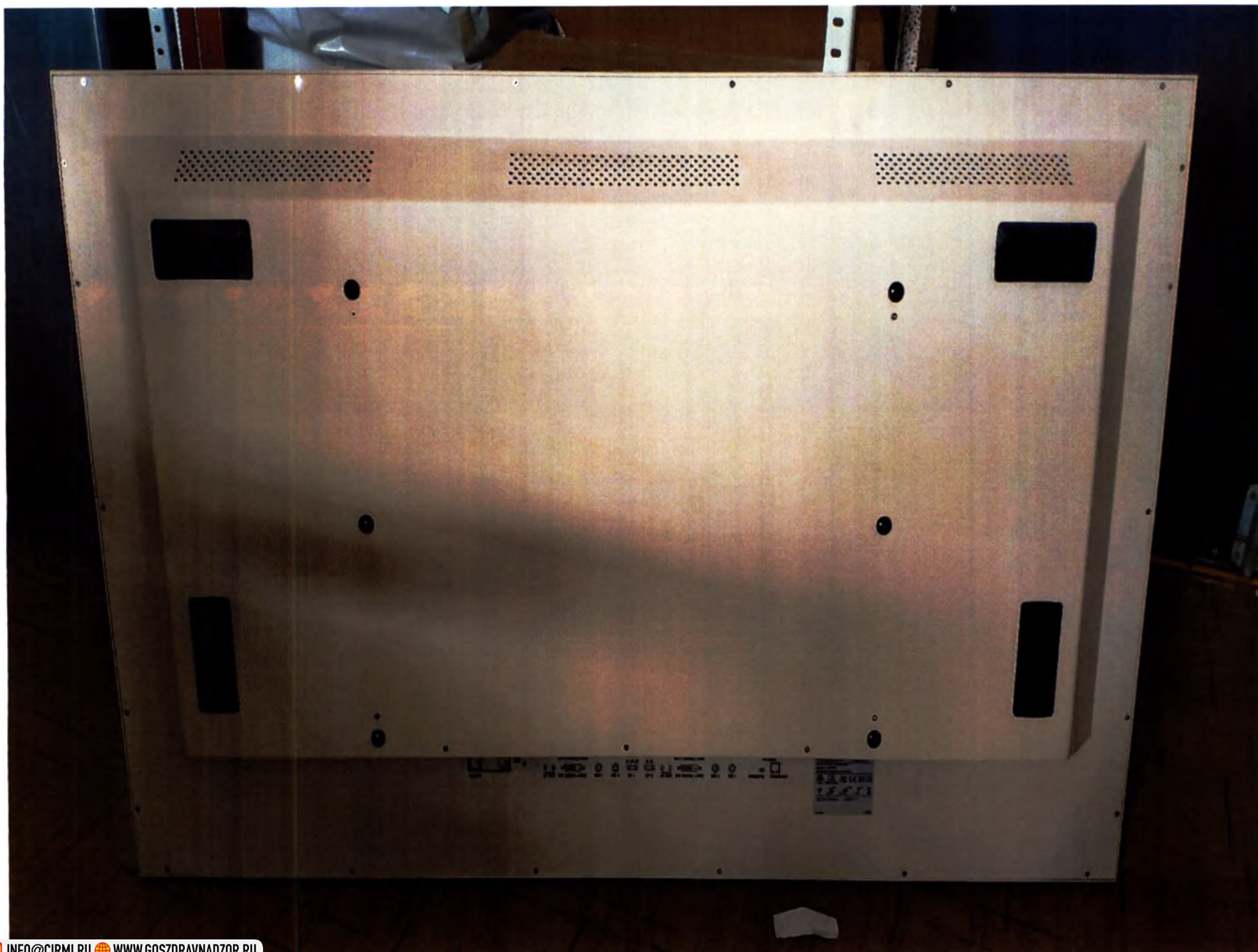
Монитор LCD медицинского назначения, модель FS-L5502D с диагональю 55''(139,7 см): Тыльная сторона
