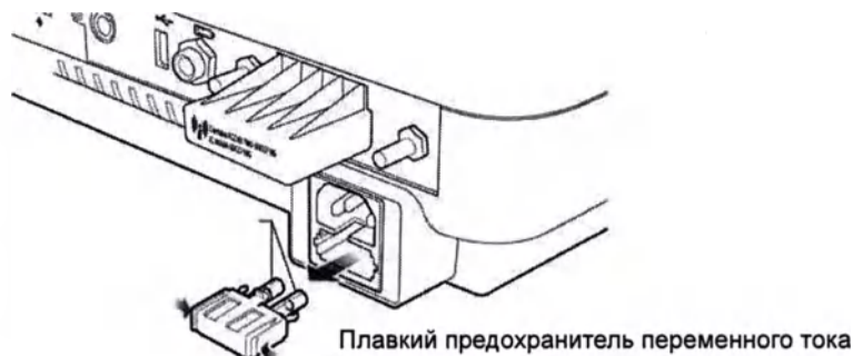
Рис. 5-6 Замена плавкого предохранителя переменного тока
