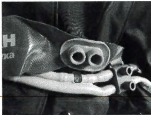
РИС.1 Положения клапана быстрого сброса воздуха
