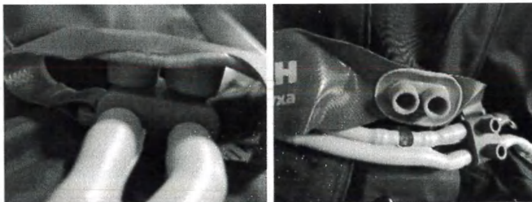
Клапан быстрого сброса воздуха закрыт Клапан быстрого сброса воздуха открыт
