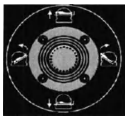
Джойстик 2: Подъем и наклон стола
