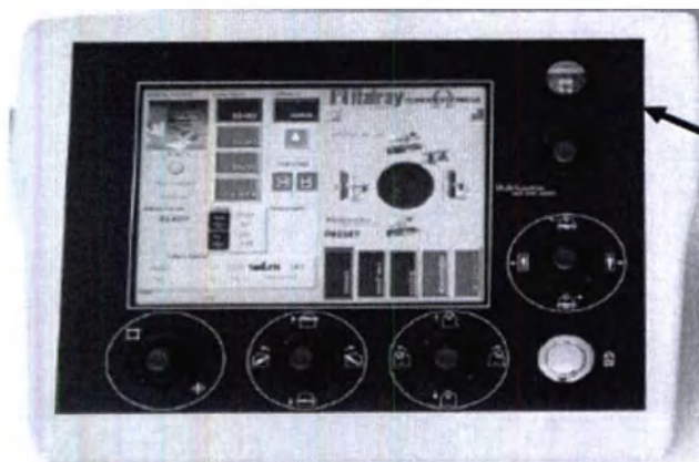
Рисунок 1.18 - Пульт управления. Расположение кнопки аварийного отключения.
