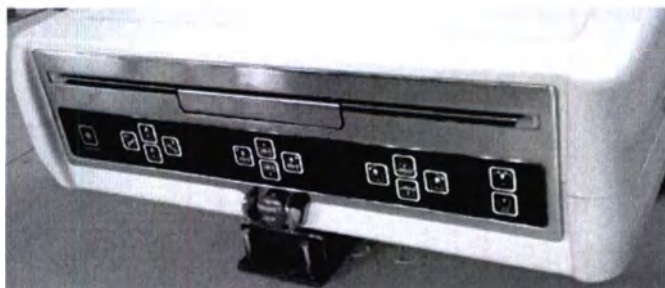
Рисунок 1.19 – Стол-штатив. Расположение кнопки аварийного отключения.
