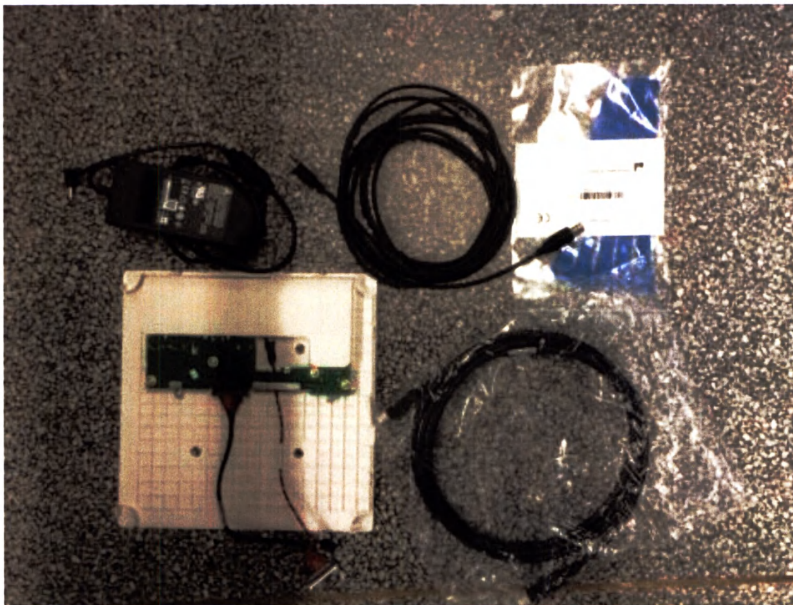
Набор для вспомогательного дисплея, в составе: основной блок – 1 шт., адаптер – 1 шт., кабель – 2 шт., фиксирующие ленты – 5 шт
