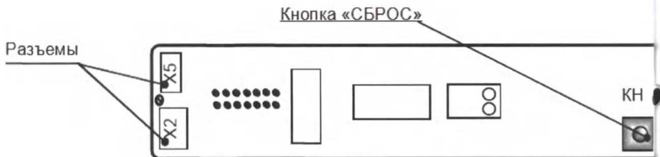
Рисунок 4.4 – схема расположения кнопки обнуления счётчика
