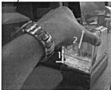
Рис.3.12 Для того, чтобы снять с держателя штатива штатив для реагентов (MACS Reagents Rack), мягко надавите на штатив в направлении, указанном стрелкой 1, а затем поднимите штатив вверх в направлении, указанном стрелкой 2.
