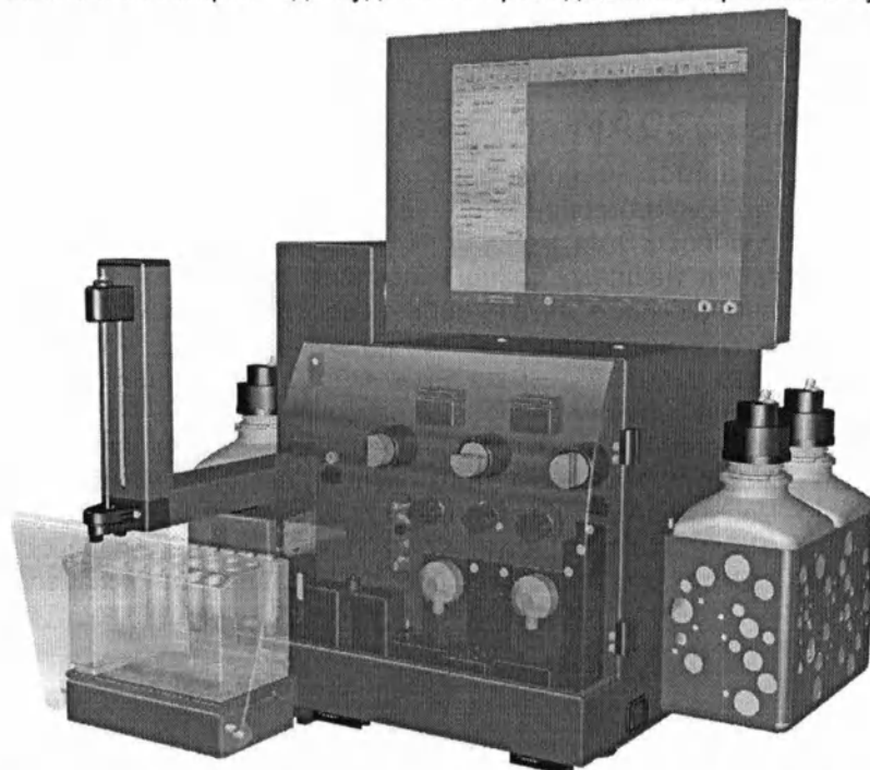
Рис. 2.7. Схематическое изображение анализатора MACSQuant – вид спереди. Передняя крышка прибора изображена прозрачной для наглядности.
