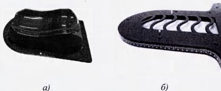
Рисунок 9 – Подголовник: а – полый подголовник, б – место крепления подголовника
