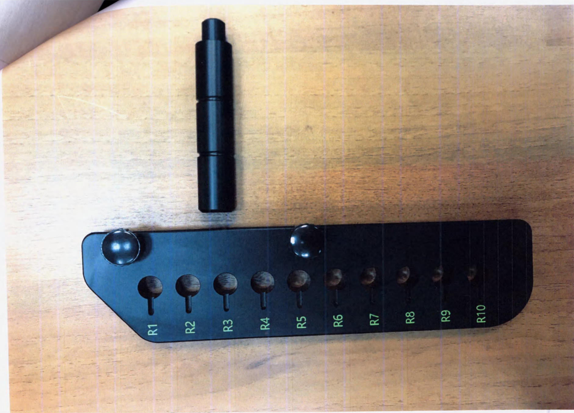
Фиксатор для крепления опорной плиты к деке терапевтического стола
