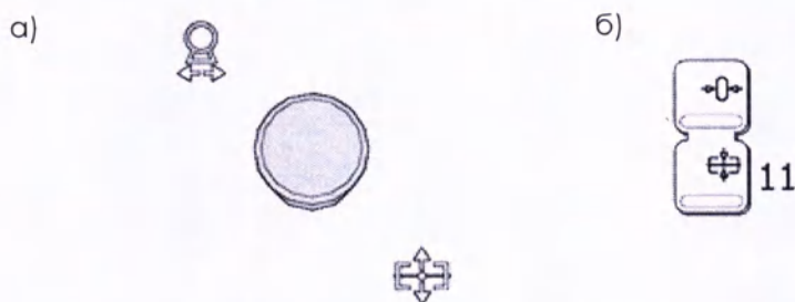
Рисунок 2.7 – Джойстик для регулировки движения деки и каретки (а) и кнопка центровки деки стола 11 на панели управления (б)
