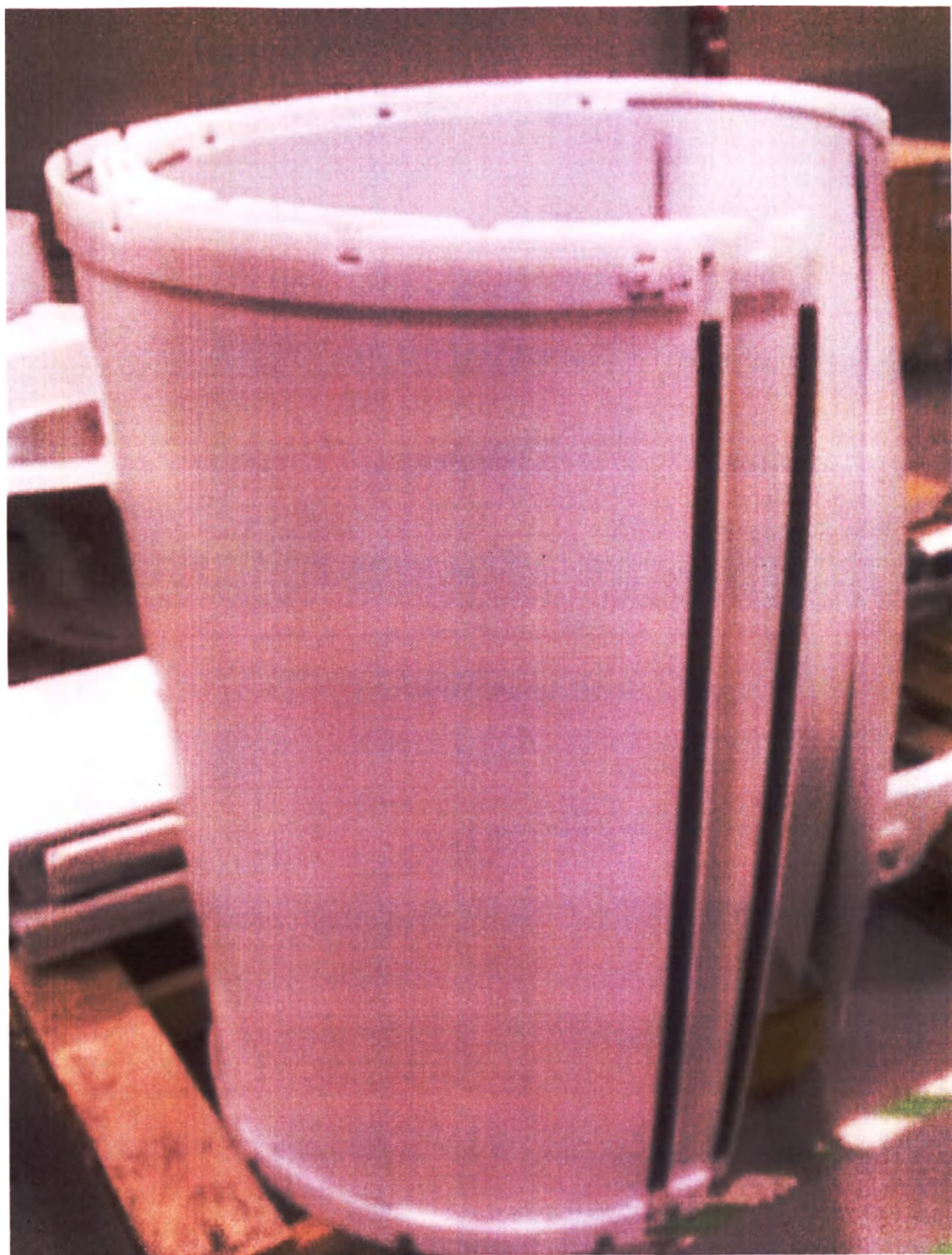
Кожухи магнита со встроенными системой связи с пациентом, системой вентиляции и освещения в туннеле.
