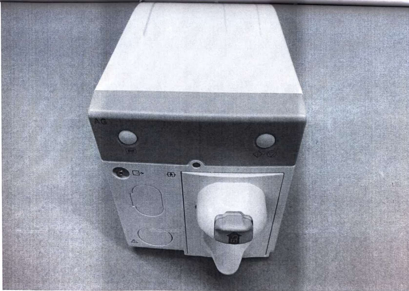
29. Модуль газоанализа, с автоматическим определением анестетика, с мониторингом кислорода, без расходных материалов,
