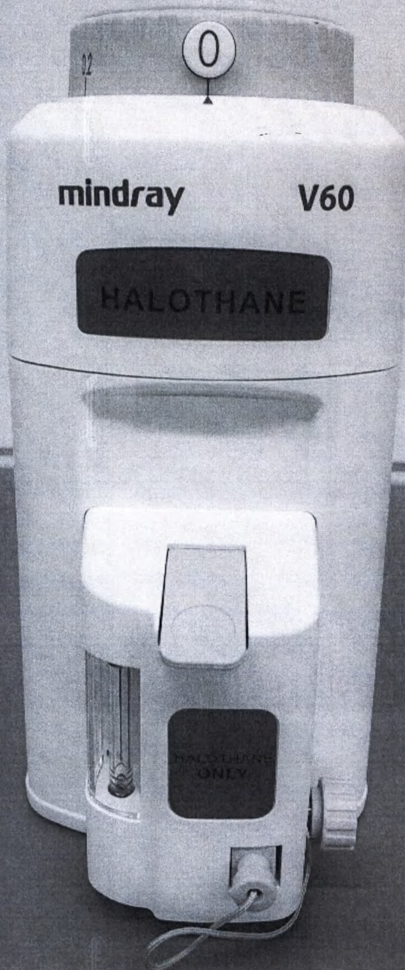
10. Испаритель анестетика Галотан V60 (Key-Fill), с адаптером Key-Fil, г-ва Shenzhen Mindray Bio-Medical Electronics Co., Ltd., Китай.
