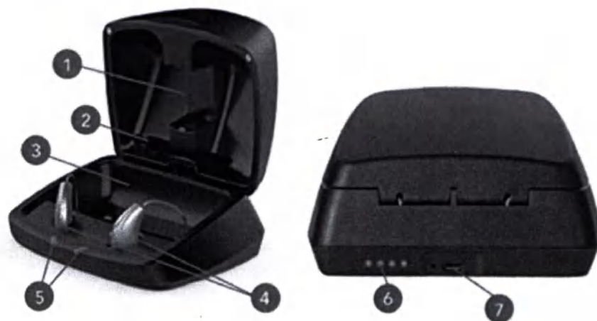
Рисунок 9 – Составные части футляр-зарядного устройства для СА RIC R: 1 – Держатель 31x12мм для сушильной капсулы (таблетки)*. 2 – Держатель щётки для чистки СА. 3 – Отсек для ушных вкладышей с RIC. 4 – Зарядные порты. 5 – Индикаторы заряда слухового аппарата. 6 – Светодиодные индикаторы заряда зарядного устройства. 7 – Micro USB порт.
