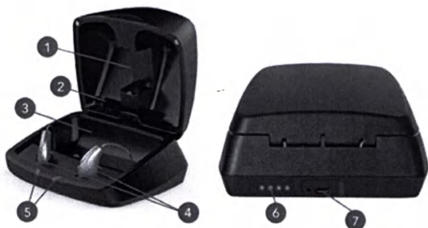
Рисунок 3 – Составные части футляр-зарядного устройства для CA RIC R: 1 – Держатель 31x12мм для сушильной капсулы (таблетки)*. 2 – Держатель щётки для чистки CA. 3 – Отсек для ушных вкладышей с RIC. 4 – Зарядные порты. 5 – Индикаторы заряда слухового аппарата. 6 – Светодиодные индикаторы заряда зарядного устройства. 7 – Micro USB порт.
