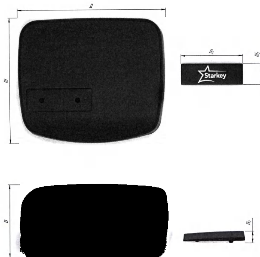
Рисунок 4 – Внешний вид и размеры футляра пластикового с биркой STARKEY
