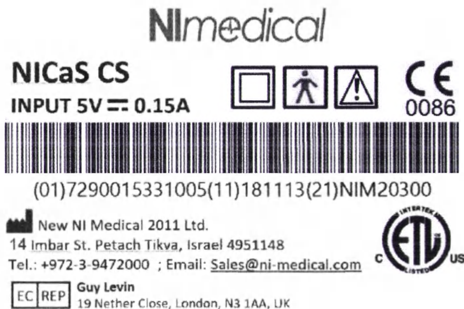
Рисунок – Образец маркировки системы для неинвазивного исследования центральной гемодинамики методом биоимпедансометрии NICaS CS
