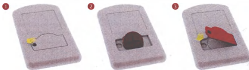
Рис. 45 Замена батареи FineTuner
