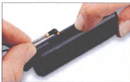
Рис. 18 Подключение внешних аудиоустройств к гнезду CS44 миниатюрного блока элементов питания
