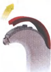
Рис. 36 Снятие крышки микрофона
