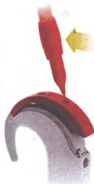
Рис. 34 Снятие крышки микрофона
