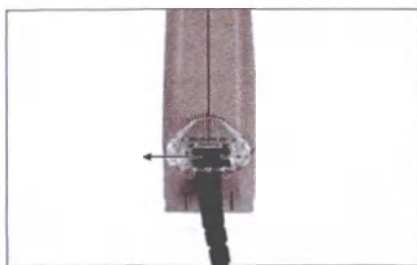
Рис. 16 Предохранительная защелка для OPUS 2 блока процессора
