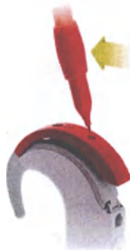
Рис. 35 Снятие крышки микрофона
