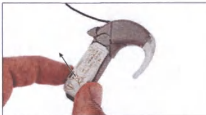
Рис. 11 Удаление аккумулятора DaСаро из блока питания аккумуляторного DaСаро
