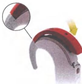
Рис. 35 Установка крышки микрофона
