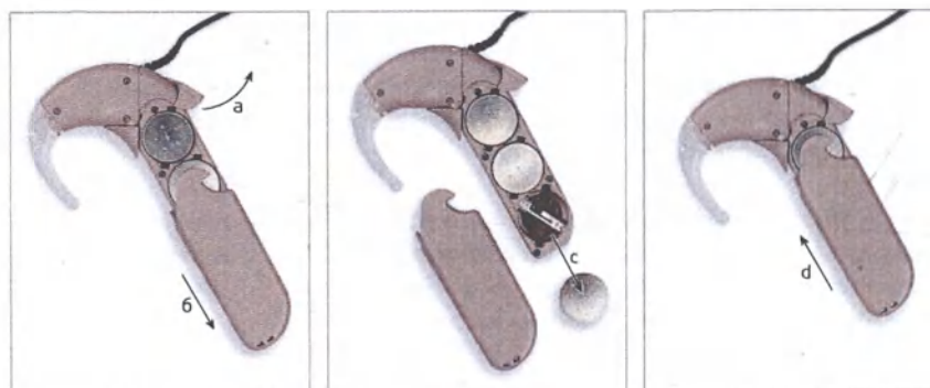
Рис. 23 Извлечение батарей аудиопроцессора
