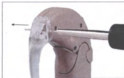
Рис. 20 Как удалить штырь заушины
