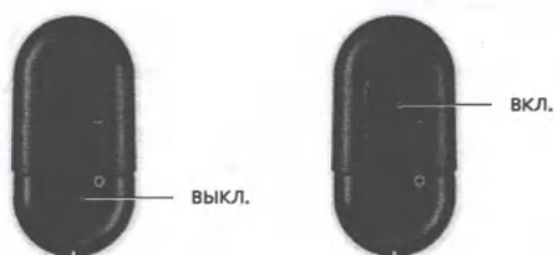
Рис. 11 Переключатель ВКЛ./ВЫКЛ. (блокировка батарейного отсека)
