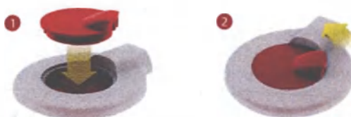
Рис. 22 Установка магнита передатчика типа D
