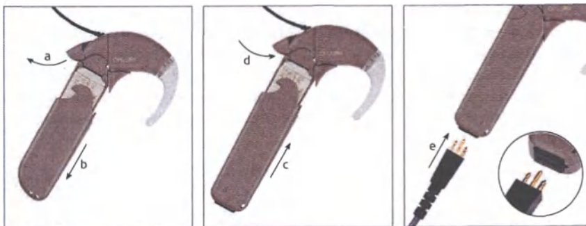
Рис. 7 Подключение FM кабеля к аудиопроцессору OPUS 2
