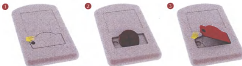
рис. 41 Замена батареи FineTuner
