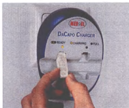
Рис. 9 Установка аккумулятора DaCapo в зарядное устройство DaCapo
