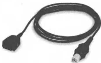
Рис. 2c RONDO 2 соединительный кабель миниатюрного блока элементов питания (для аудиопроцессора RONDO 2)
