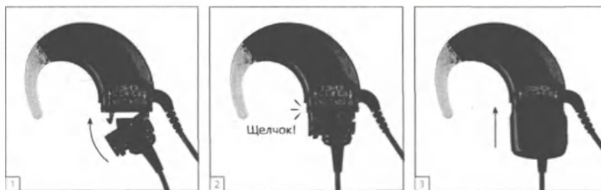
Рис. 5 Подключение разъема SONNET ActiveWear к блоку процессора
