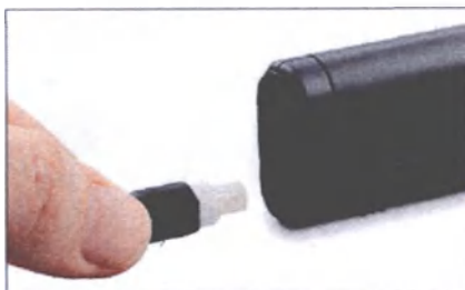
Рис. 8 Подключение соединительного кабеля к миниатюрному блоку элементов питания
