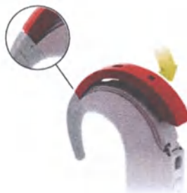
Рис. 36 Установка крышки микрофона
