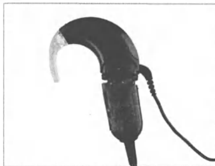
Рис. 13 Подключение MAX кабеля для программирования SONNET/SONNET 2
