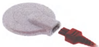
Рис. 27 Подключение SONNET кабеля передатчика типа D к передатчику типа D
