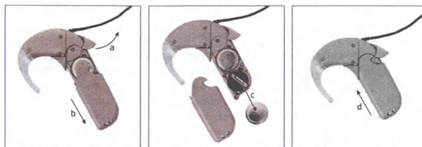
Рис. 11. Замена элементов питания
