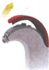
Рис. 37 Снятие крышки микрофона
