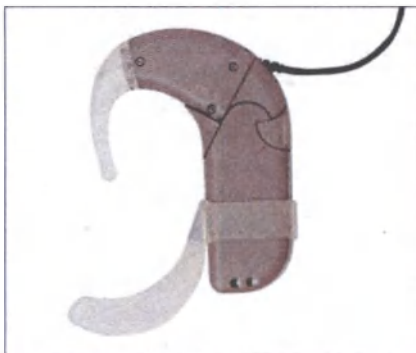
Рис. 10. Спортивный заушный крючок, прикрепленный к аудиопроцессору
