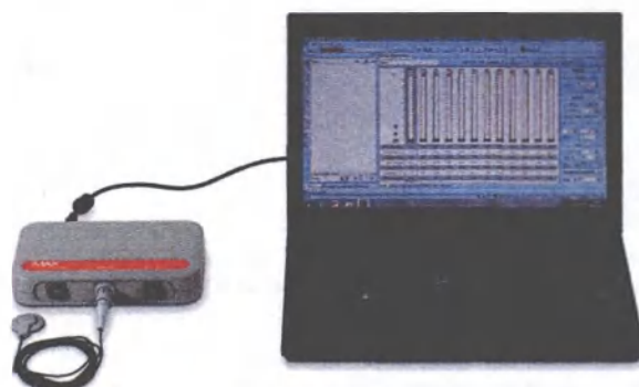
Рис. 23 Установка для оценки телеметрии и ESRT
