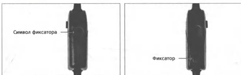
Рис. 12 Символ фиксатора напротив фиксатора кожуха разъема SONNET ActiveWear
