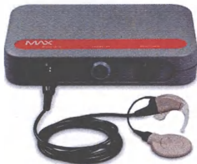
Рис. 16 Подключение аудиопроцессора OPUS 2 к MAX Программному интерфейсу
