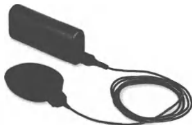
Рис. 14. Миниатюрный блок элементов питания, подсоединенный к аудиопроцессору RONDO 2
