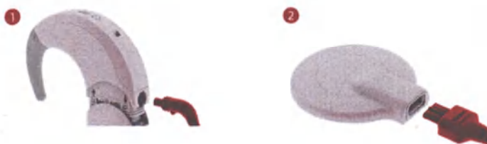
Рис. 27 Отсоединение SONNET кабеля передатчика типа D
