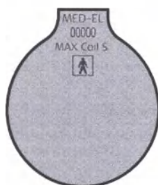
Рис. 28 Маркировка MAX Coil S
