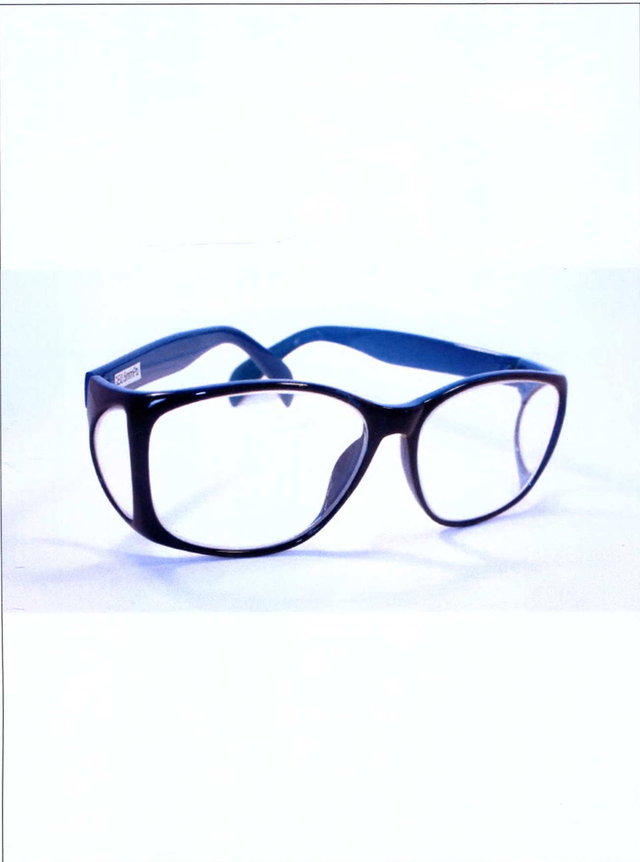
Рис. 22а – Очки рентгенозащитные, варианты исполнения: - Очки рентгенозащитные РЗО-0,5, свинцовый эквивалент: (фронтальный/боковой) 0,5/0,5 mmPb - Очки рентгенозащитные РЗО-0,75, свинцовый эквивалент: (фронтальный/боковой) 0,75/0,75 mmPb, 0,75/0,5 mmPb
