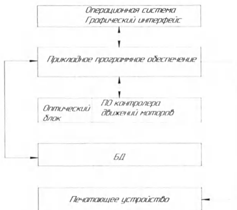
Рисунок 12 – Структурная схема ПО
