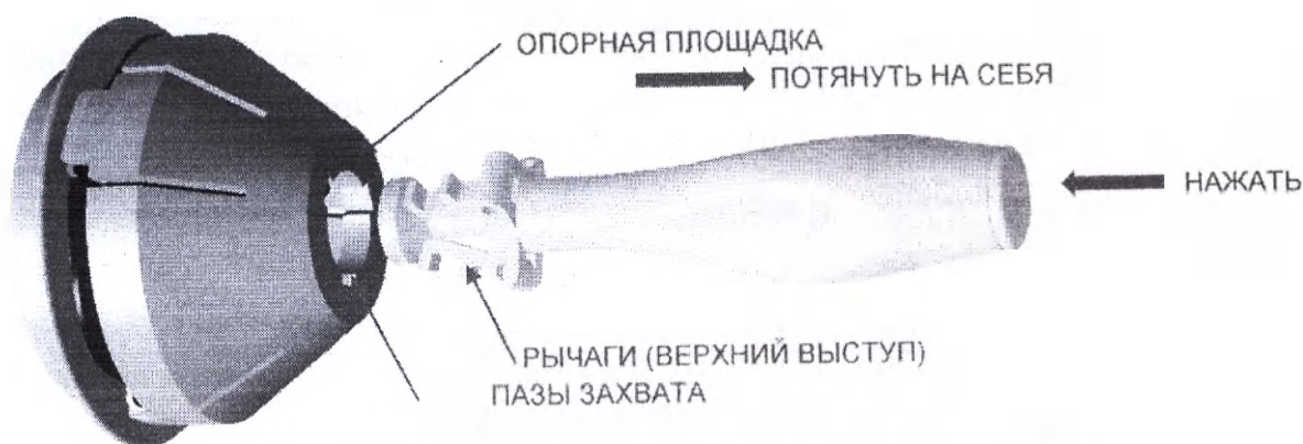
Рисунок 10 – Разъединение ручки и захвата держателя
