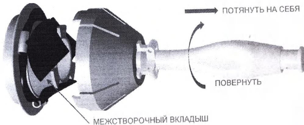
Рисунок 11 – Снятие держателя с ПКС
