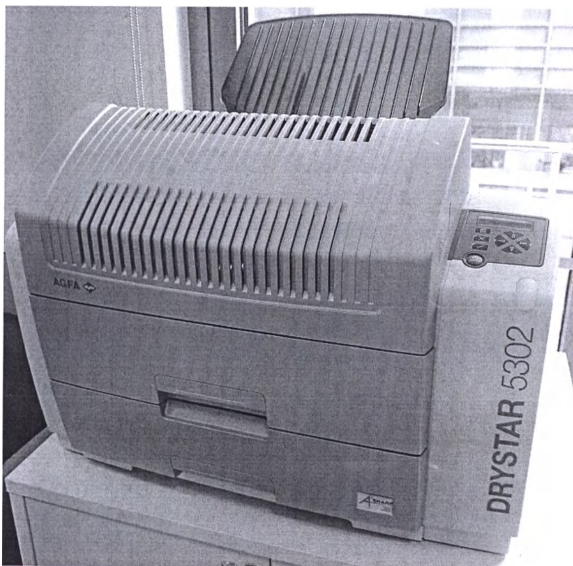
Камера мультиматная термографическая Drystar 5302 производства Agfa N.V., Бельгия
