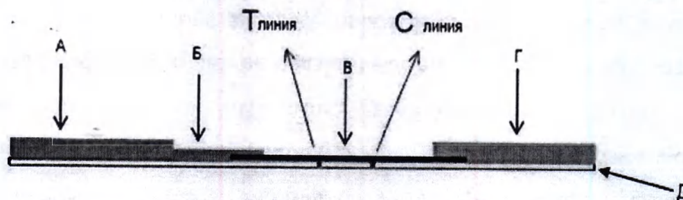
Рисунок 2 – Структура тест-полоски для выявления наркотических веществ и их метаболитов
