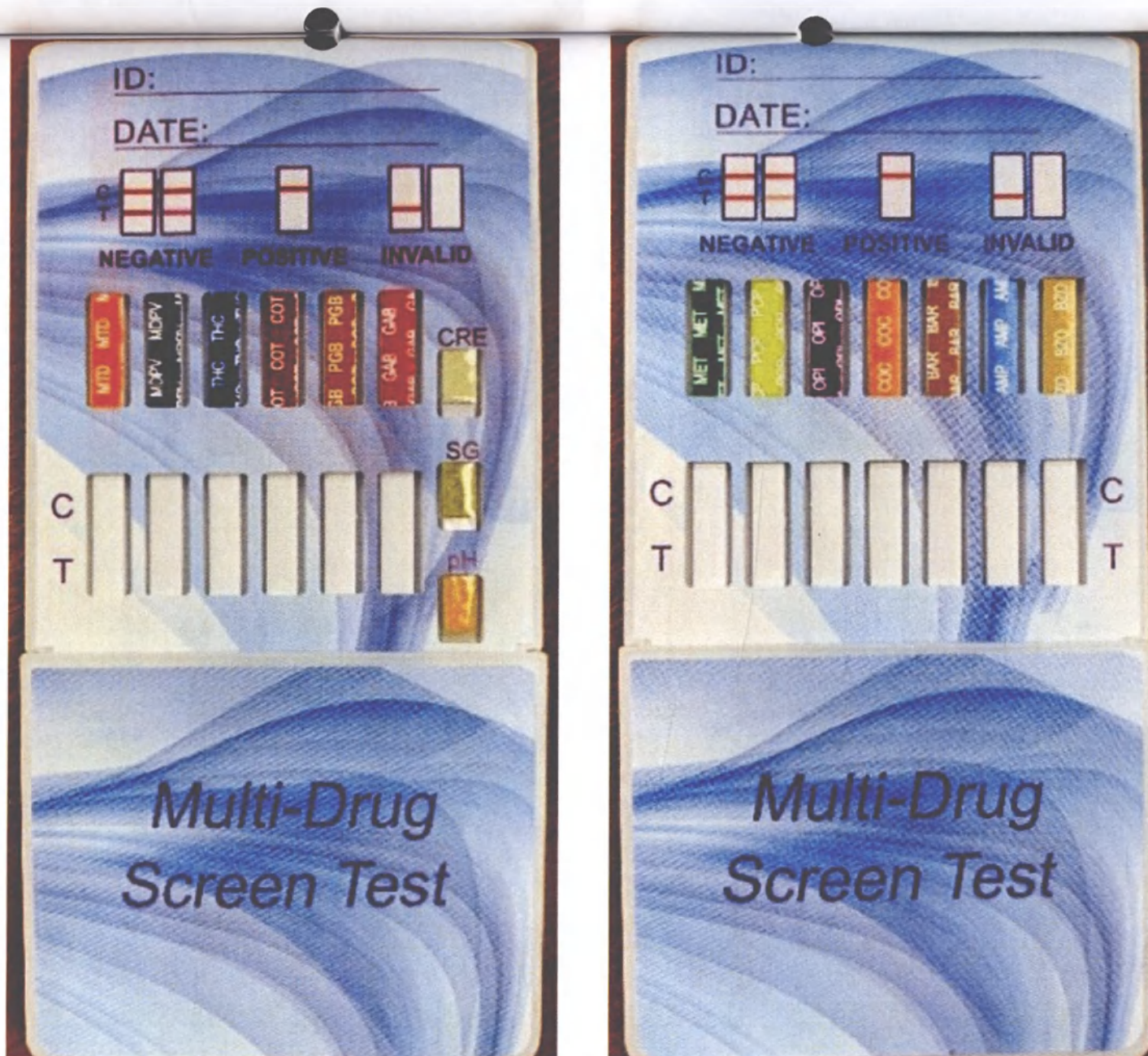
Рисунок 2 Вариант исполнения 2: Тест-панель для выявления 13 наркотических веществ и их метаболитов в моче иммунохроматографическим методом (Сторона 1 и 2)
