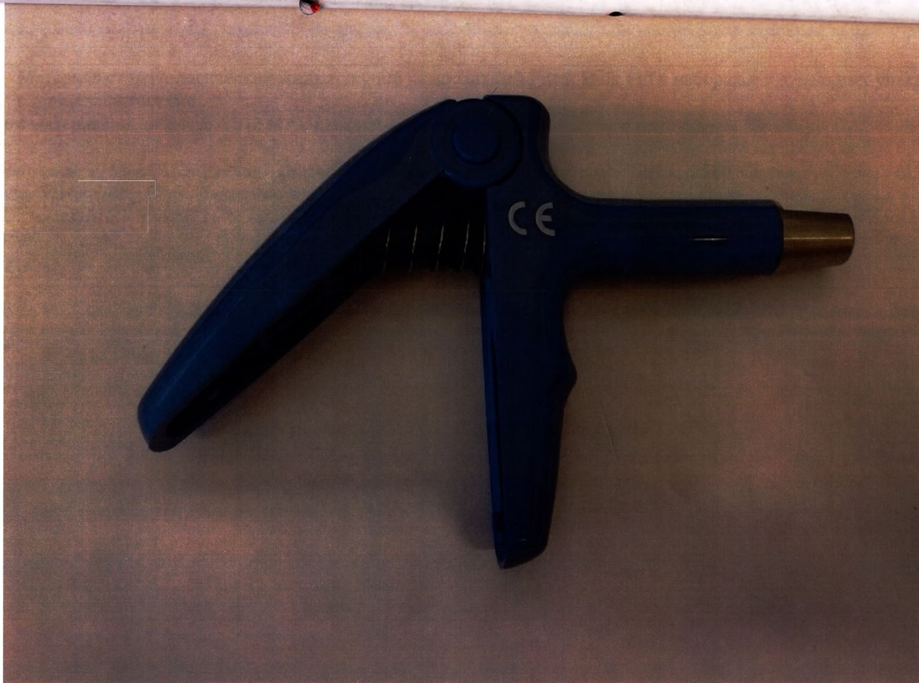
2. Диспенсер для внесения материала
