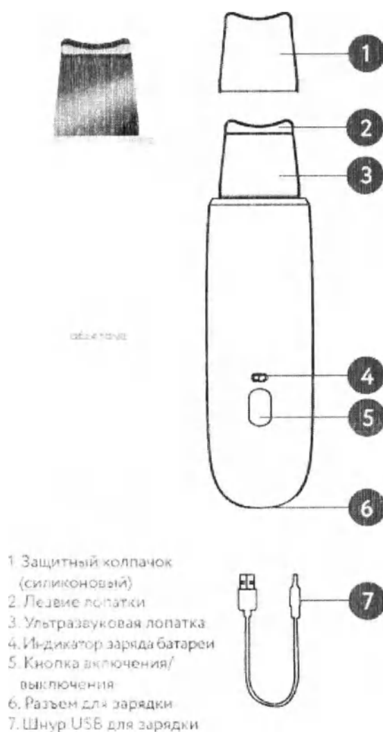
Рис. А Внешний вид и конструкция прибора модели Bio Sonic 730
