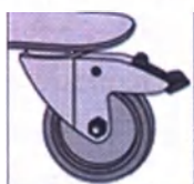
Положение педали при разблокированных колесах
