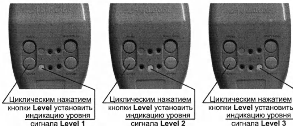
Рисунок 4.1 – Установка и индикация уровней Level 1, Level 2 и Level 3 аппарата «Акватон-05».
