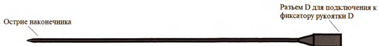
Наконечник для ультразвукового зонда с рукояткой D (длина 185 мм, диаметр 2,5 мм)
