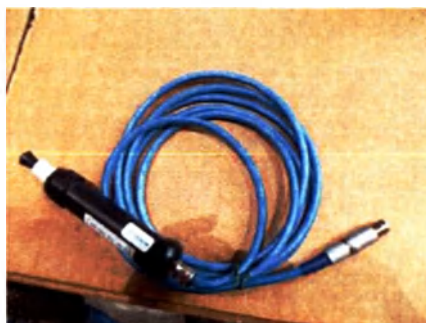
Рис. 5 Ультразвуковой зонд с рукояткой MANCELL
