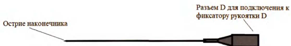
Наконечник для ультразвукового зонда с рукояткой D (длина 120 мм, диаметр 2,0 мм)
