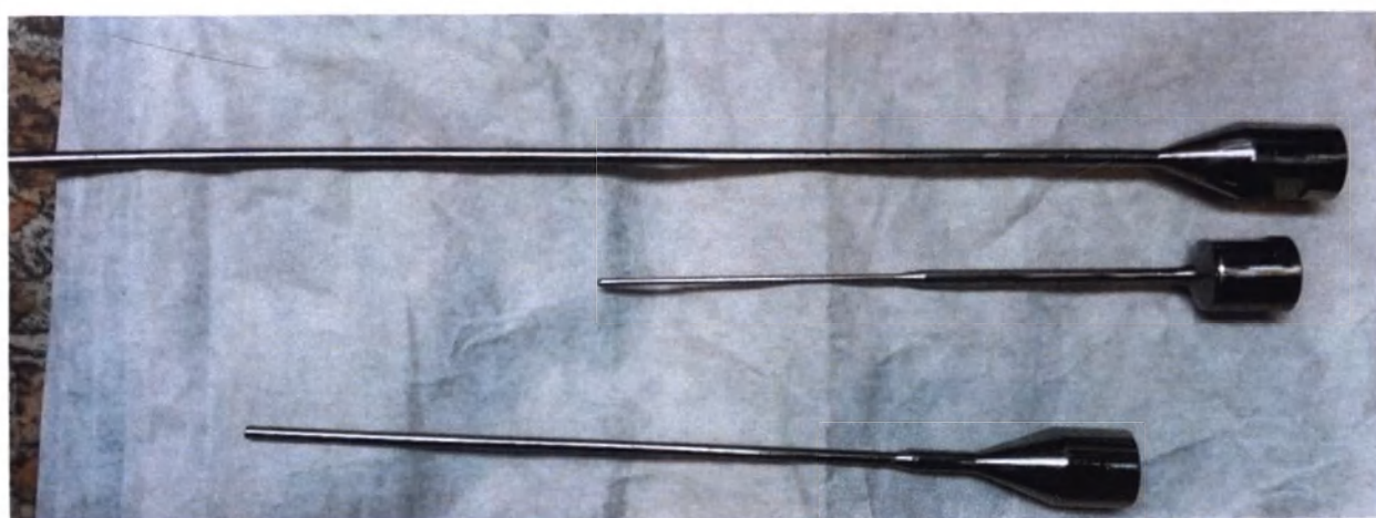
Наконечник для ультразвукового зонда с рукояткой D (длина 185 мм, диаметр 2,5 мм)
