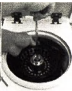
Инструмент для ротора без гайки.
