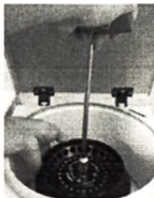
Инструмент для ротора с гайкой.
