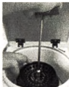
Инструмент для ротора с гайкой.
