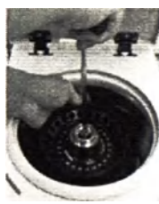
Инструмент для ротора без гайки
