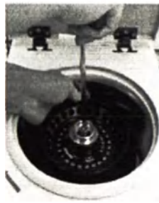
Инструмент для ротора без гайки.
