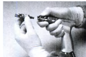
Рис. 2-5. Сборка цанговых патронов Hudson и Zimmer
