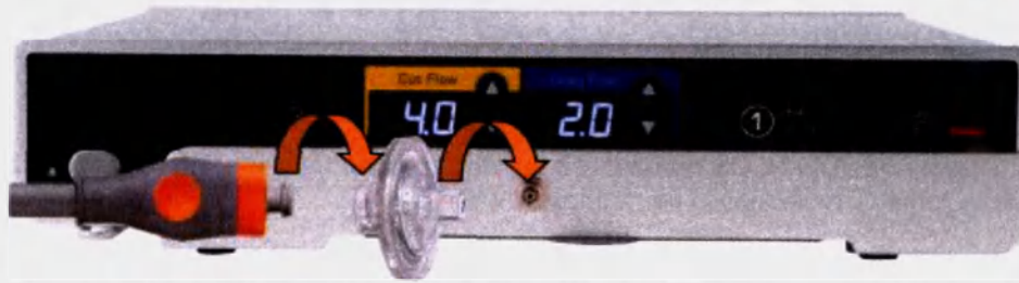
Рис. 4-2: Установка стерилизующего фильтра и аргонового кабеля на ARC PLUS I / ENDO PLUS
