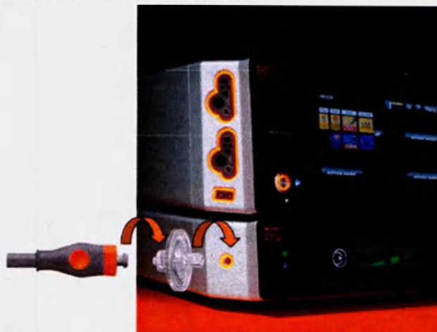
Рис. 4-5: Монтаж стерилизующего фильтра и магистрального кабеля системы подачи аргона на аппарате ARC PLUS II
