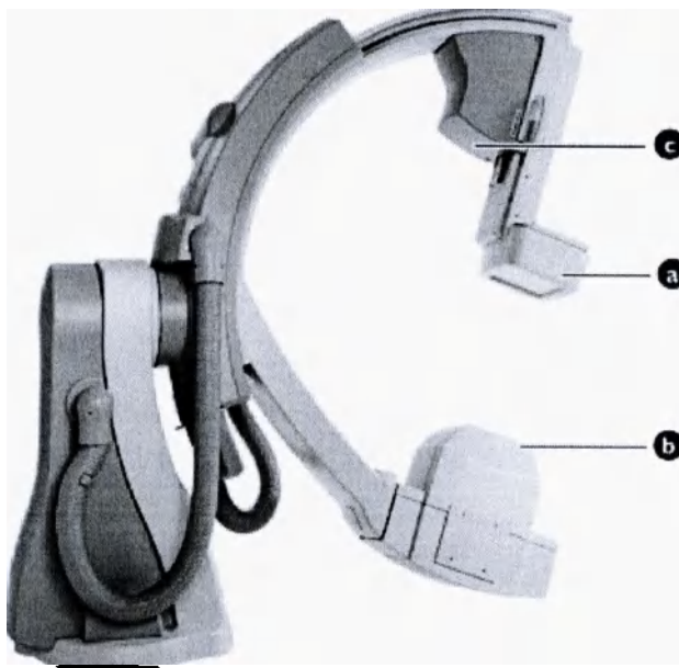
Рисунок 3.9 Датчики BodyGuard на системе FD10
