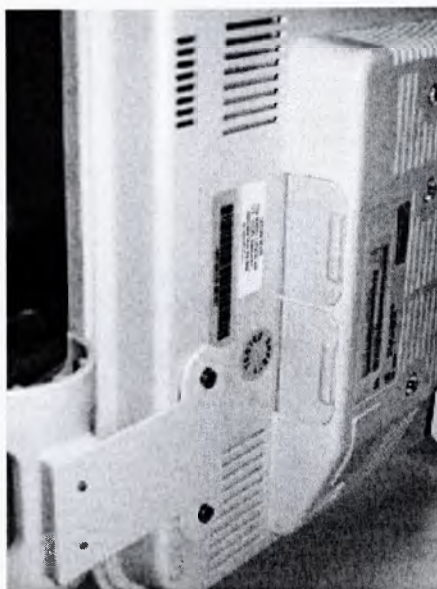
Рисунок 2.29 Модуль Xper — откидные дверцы отсека USB
