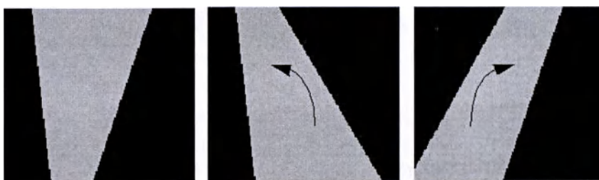
Рисунок 4.2 Клиновидные фильтры; правый клин вращается против часовой стрелки из исходной позиции, левый клин вращается по часовой стрелке из исходной позиции
