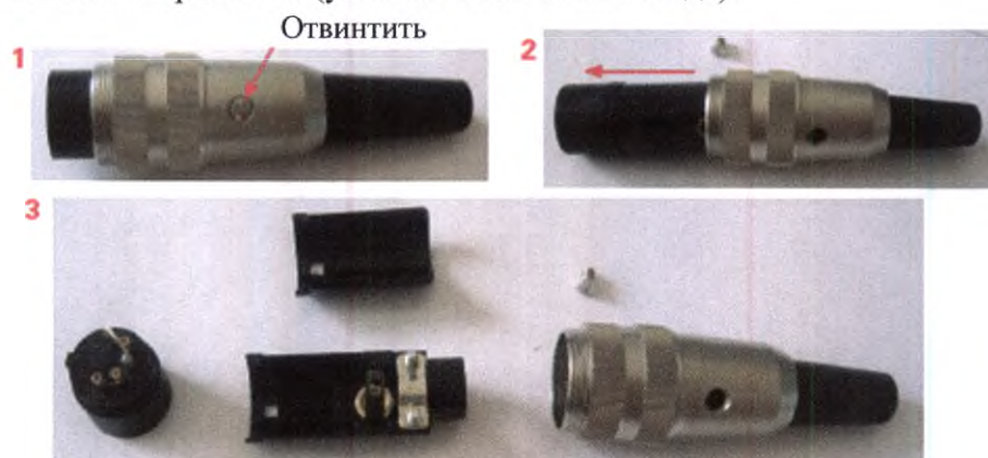
Рисунок 20 – Как открыть разъем блокировки
