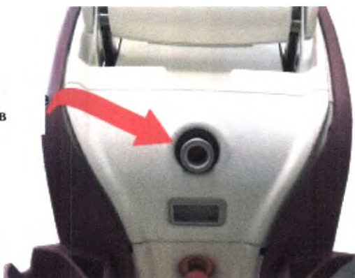
Рисунок 48 – Тестовое отверстие для лазерных манипуляторов Sparks, Insight и Prisma, Erise.
