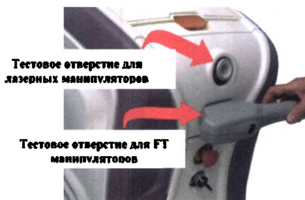
Рисунок 45 – Тестовые отверстия манипуляторов
