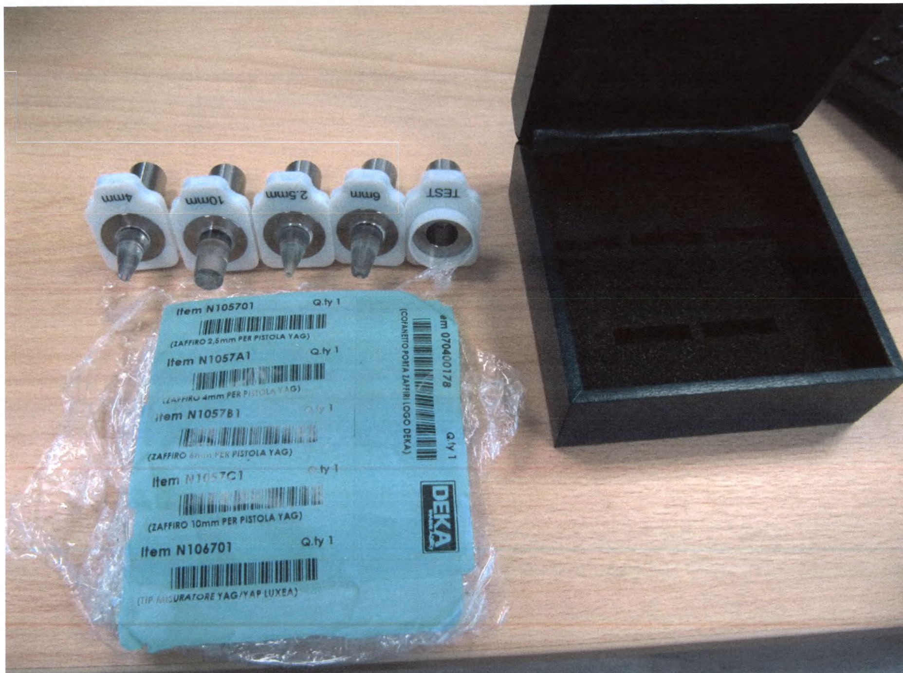
Фото 57 – Наконечники манипулятора Sparks, адаптер для проведения тестирования манипулятора.
