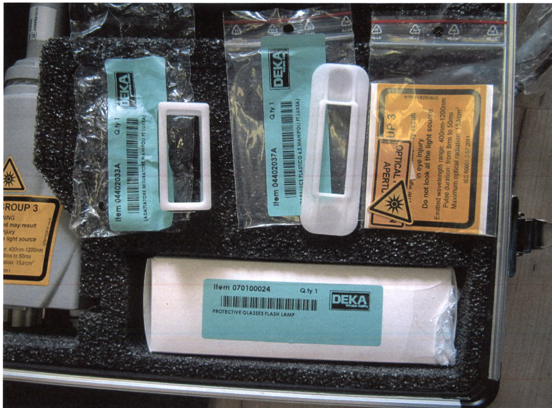
Фото 24 – Адаптер для проведения тестирования манипулятора Lazur, пластиковый колпачок, знаки предупреждающие, очки защитные для врача в упаковке.
