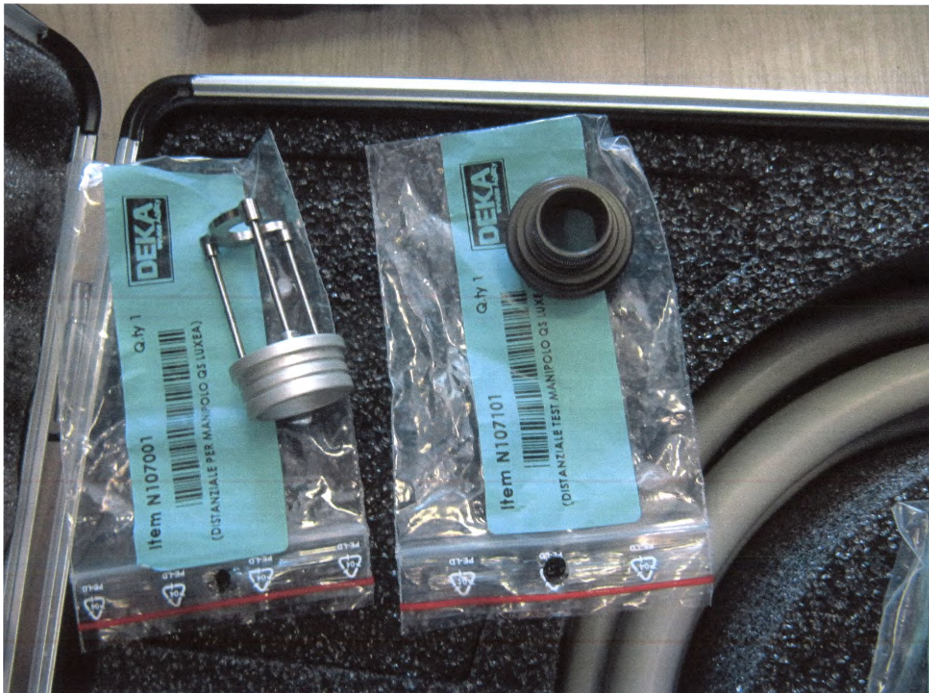
Фото 83 – Распорка, адаптер для проведения тестирования манипулятора Prisma.
