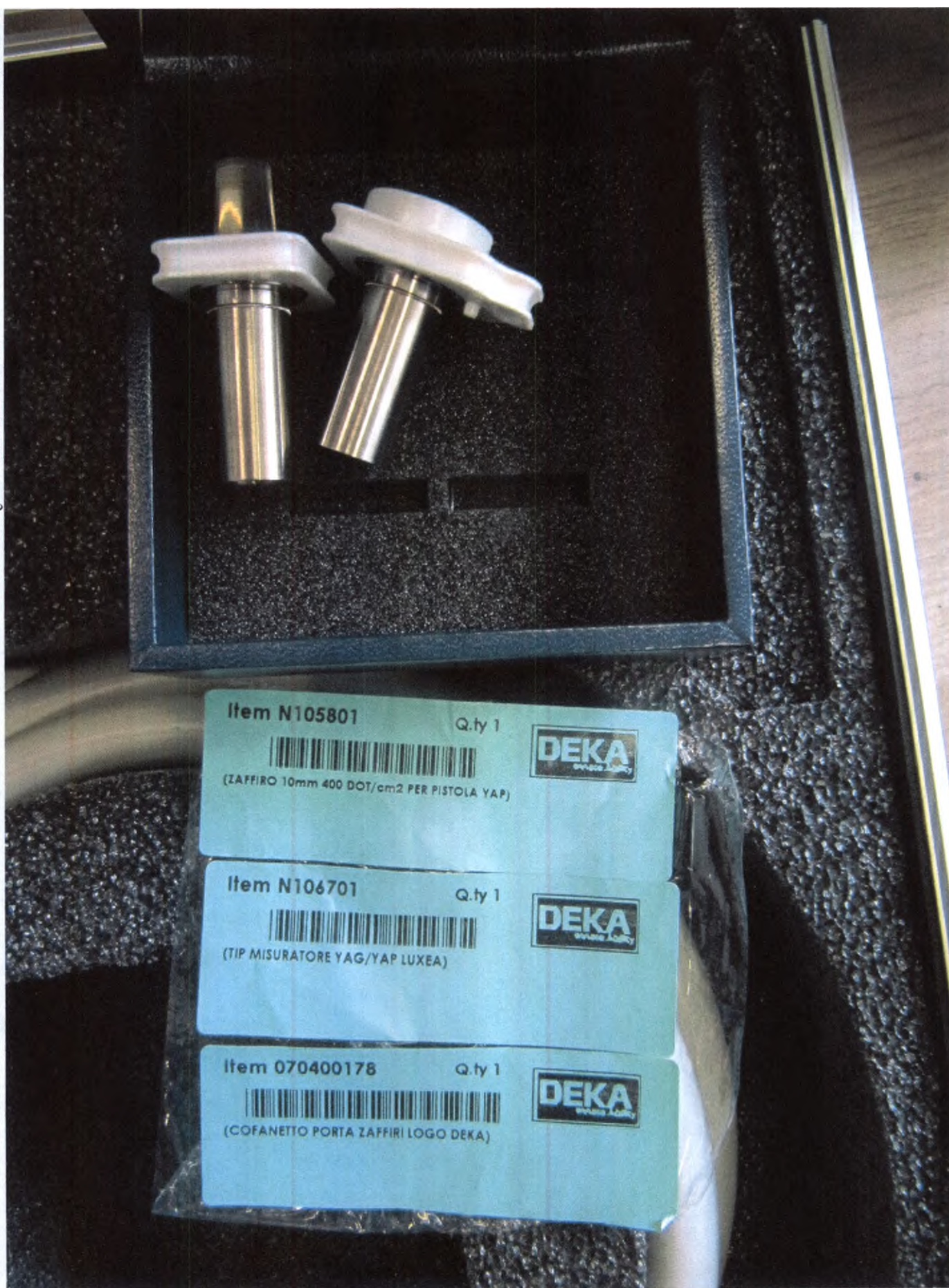
Фото 67 - Наконечник, излучающий 400 ТОЧЕК/см 2 и адаптер для проведения тестирования манипулятора в чехле для наконечника.
