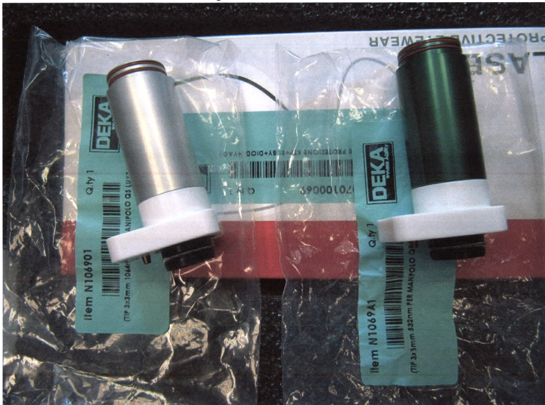
Фото 21 - Наконечник с размером лазерного пятна 3 мм × 3 мм 1064 нм и 3 мм × 3 мм 532 нм.
