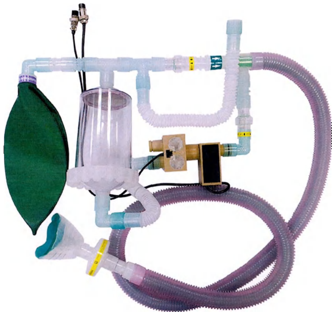
Рис. 9. Фотографическое изображение дыхательного контура в сборе. Датчик концентрации газов и электромеханический клапан повернуты на 90° в плоскости рисунка относительно нормального расположения для наглядности.
